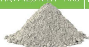
Particolarmente indicato nelle applicazioni speciali ad alto contenuto tecnico, il cemento d'altoforno è flessibile a tutti gli impieghi, per soluzioni durevoli ed ecocompatibili. I cementi d'altoforno, prodotti in accordo alla EN 197-1, sono costituiti da una miscela di clinker, gesso e loppa granulata d'altoforno che conferisce al calcestruzzo prodotto un'elevata durabilità, rispondendo alle prescrizioni delle Norme Tecniche DM 14/01/2008.
